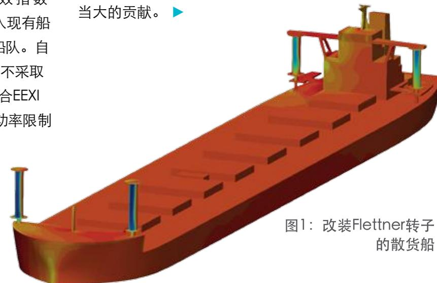
图1：改装Flettner转子的散货船
